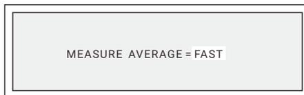
在此模式下，若是待测物有剧烈的电压电流变化，可改变平均测量次数来让VFD的显示值更加稳定。显示频率有FAST(快)/MEDIUM(中)/SLOW(慢)可供选择。
