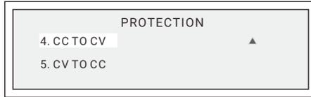
在此界面下按下 **Enter** 键进入以下界面，按 **△▽** 键开启或关闭定电流转换成定电压的保护。
